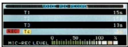
Bild 13: Zum CW-Speicher hat sich ein Voice-recorder gesellt, der für Senden und Empfang je viermal 15 s Aufzeichnungsdauer gestattet. Er läßt sich ggf. auch als Sprach-Notizspeicher ohne Sendeamplitude „mißbrauchen“. Die Sendespeicher können außerdem noch Namen erhalten.
