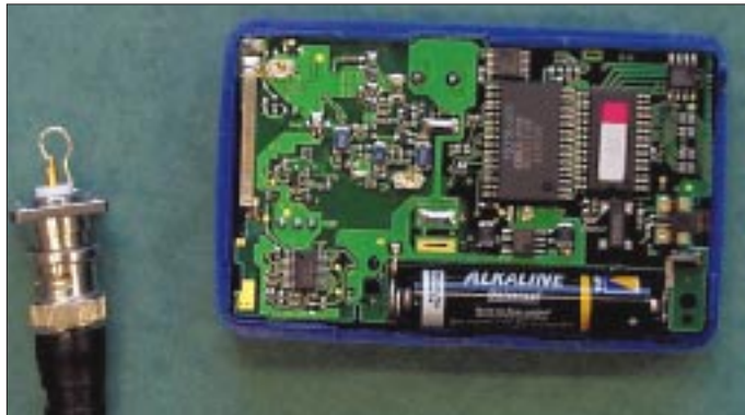
Bild 15: Eine kleine Drahtschleife am Ende des Meßkabels dient zur Einkopplung des Meßgenerator-signals.
