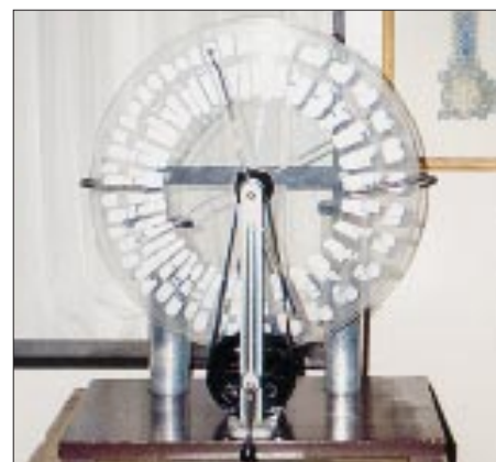
Eine sehr gut erhaltene Influenzmaschine
