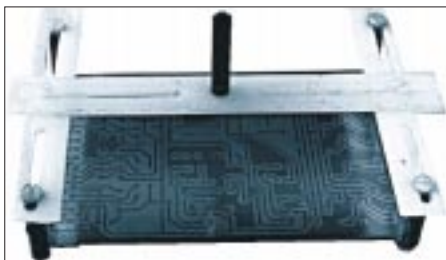
Bild 29: Eine entwickelte und gespülte doppelseitige Platine 100 mm x 130 mm, eingespannt in eine Selbstbauhalterung. In dieser Form wurde sie vorher in die Entwicklerschale gesetzt.
